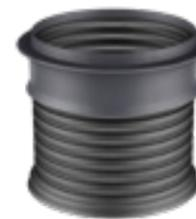
Die Domschacht-Verlängerung (Ø 62 cm) ist stufenlos teleskopierbar/kürzbar und für den frostsicheren Einbau geeignet. Sie ist zudem um 5° neigbar. Damit können Sie Ihre Tankabdeckung komfortabel und millimetergenau an Ihre Geländeoberfläche anpassen.
