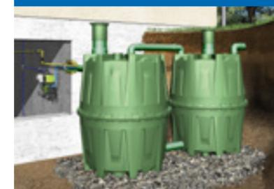
Unter Verwendung von Zubehörteilen wie Stützrohr und Tankdom kann der Herkules-Tank unterirdisch installiert werden. Der Tank kann bis zur Behälteroberkante in Grundwasser eingebaut werden.
